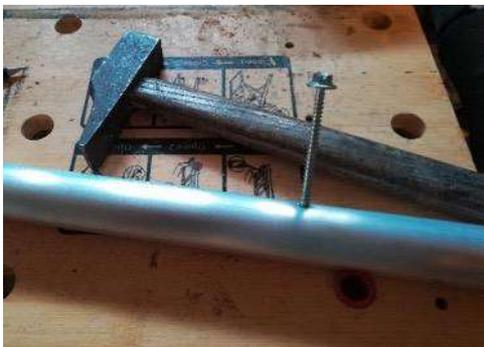
Insérer à nouveau le tube dans le pieu au travers des calles et visser la visse dans le trou réalisé par la perceuse à colonne
