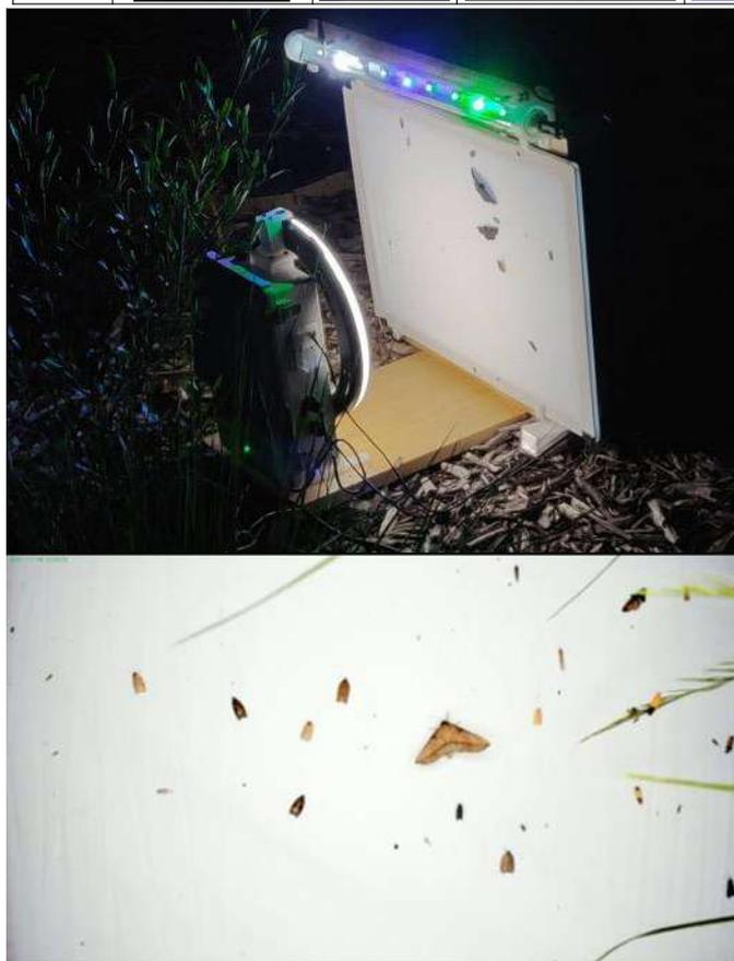
Figure 11 : Dispositif issu de Bjerge et al. (2021) et adapté par Donald Bohern, ainsi qu'un exemple de photographie issu de ce dispositif
