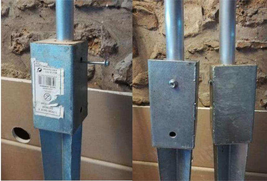
Prendre le second tube en aluminium et percer un trou de diamètre 5mm à l'aide de la perceuse à colonne à environ 10cm du bord. Prendre la vis adaptative mâle-mâle et l'emboutir à l'aide d'un marteau. Visser ensuite la vis dans le trou puis le support de téléphone portable dessus.
