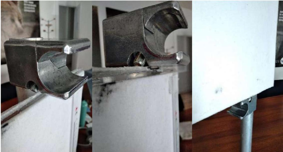
Figure 32 : Positionnement de la feutrine par rapport aux raccords tubulaires
