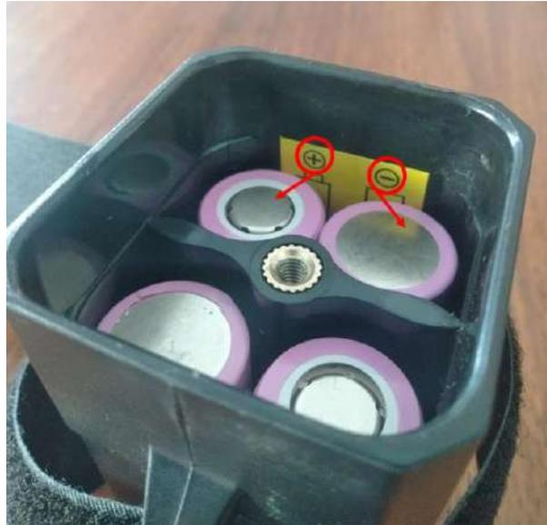
Figure 34 : Insertion des batteries dans leurs blocs
