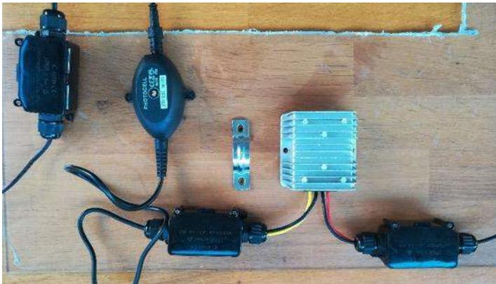
A l'aide d'un marqueur faire des marques dans l'ensemble des trous de fixation des différents éléments et percer à l'aide d'un foret de 5mm. Utiliser les vis pour fixer les différents éléments.
