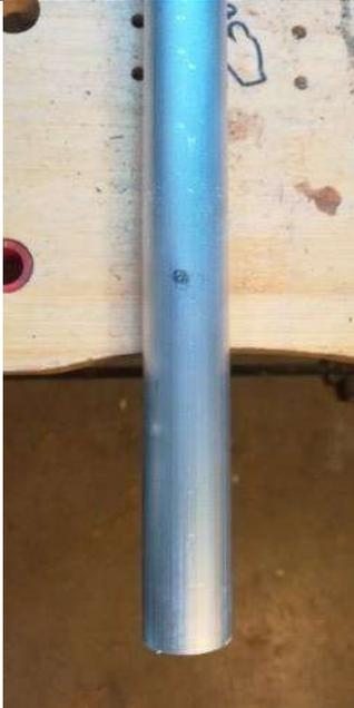
A l'aide de la perceuse à colonne faire un trou de 4mm de diamètre
