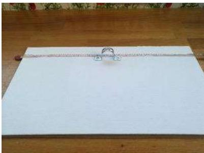
A l'aide d'une perceuse et d'un foret 5 mm percer le support et visser l'anneau de fixation à l'aide des vis.
