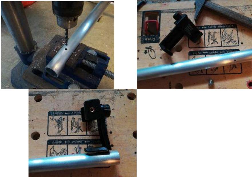
Prendre un raccord tubulaire pour fixer ensemble à la perpendiculaire les 2 tubes
