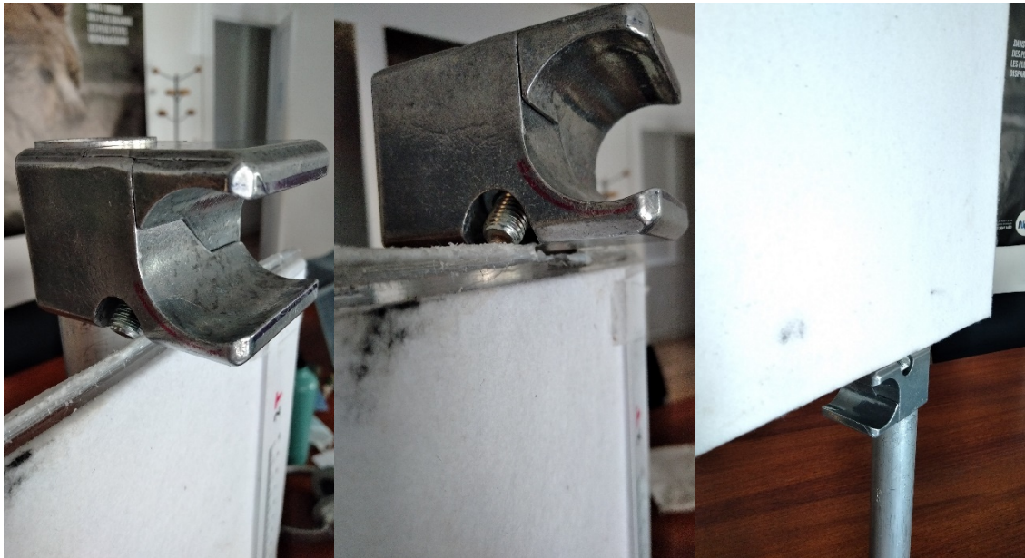
Figure 5 : Positionnement de la feutrine par rapport aux raccords tubulaires
