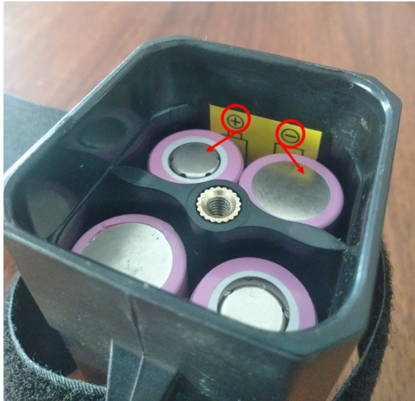
Figure 7 : Insertion des batteries dans leurs blocs
