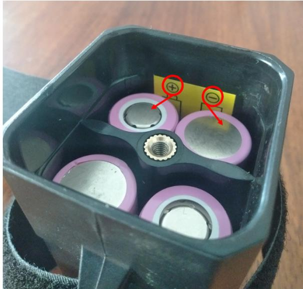
Figure 7 : Insertion des batteries dans leurs blocs
