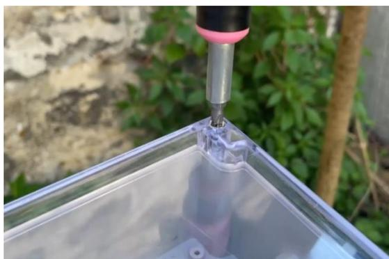
Embout PH1 et vissage du boîtier (à droite)
